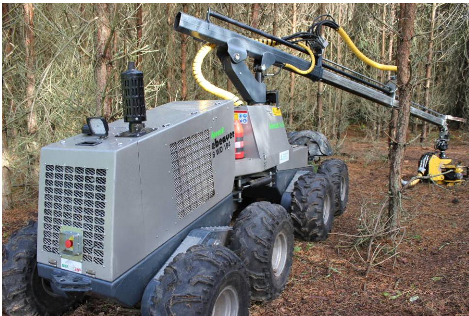
Figur 2.1. Forest ebeaver utrustad som bioenergiskördare med fällhuvud från Kesla.
